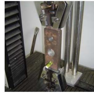
Fig 10 Shearing test equip
